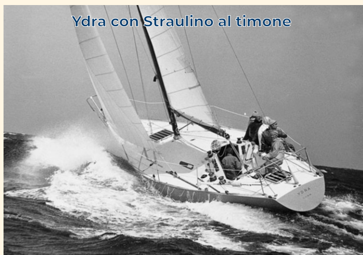
Ydra Caratteristiche: Lunghezza f. s. m 11,26 Lunghezza al gall. m 9,47 Larghezza m 2,25 Superficie velica mq 59,5
